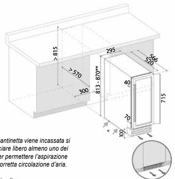
\*Attenzione: se la cantinetta viene incassata si raccomanda di lasciare libero almeno uno dei 2 fianchi inferiori per permettere l'aspirazione necessaria per la corretta circolazione d'aria.
