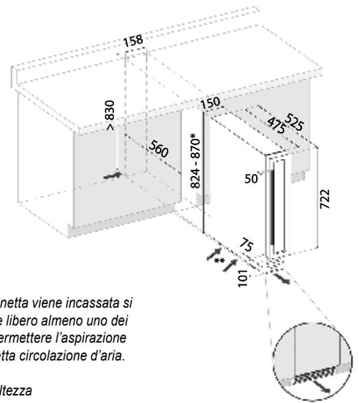
*\*Attenzione: se la cantinetta viene incassata si raccomanda di lasciare libero almeno uno dei 2 fianchi inferiori per permettere l'aspirazione necessaria per la corretta circolazione d'aria.*
