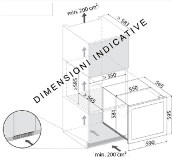
N.B. Per il corretto funzionamento del prodotto è necessario prevedere la griglia frontale di aerazione sullo zoccolo, il vuoto sanitario sul fondo del mobile ed un'uscita sulla parte alta dello stesso per l'espulsione dell'aria calda.
