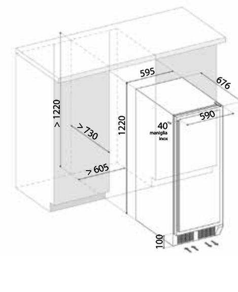
\*lo spazio tra il mobile ed il lato di incernieratura della cantinetta deve essere di almeno 3 mm. Per permettere la corretta apertura dell'anta.
