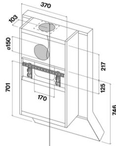
Uscita superiore: rimuovere il tampono 165x165 mm.
