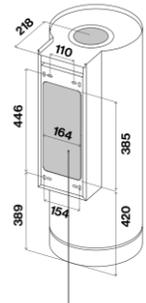
Uscita posteriore: rimuovere il tampono 385x164 mm.
