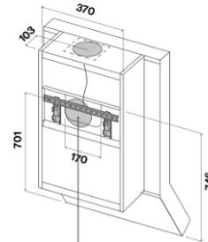
Uscita posteriore: rimuovere il tampono 170x125 mm.
