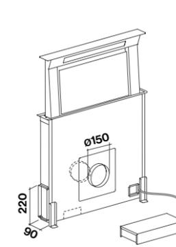
**Versione aspirante (motore 950 m³/h montato su cappa)**
