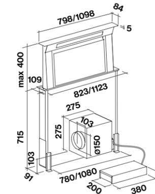
**Vista laterale installazione con motore anteriore**
