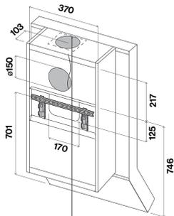
Uscita superiore: rimuovere il tampono 165x165 mm.
