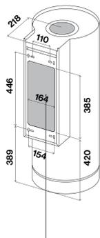
Uscita posteriore: rimuovere il tampone 385x164 mm.
