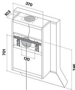
Uscita posteriore: rimuovere il tampono 170x125 mm.
