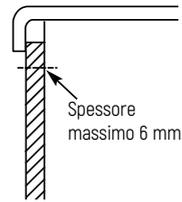
Se il pannello ha un spessore inferiore ai 6 mm è necessario realizzare un pannello di tamponamento fino a raggiungere lo spessore massimo di 6 mm (tamponamento + pannello).
