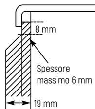
E' possibile utilizzare pannelli più spessi (spessore massimo di 19 mm) realizzando delle fresate di almeno 5,1 cm dal lato della maniglia per permettere un'impugnatura confortevole per l'utente.
